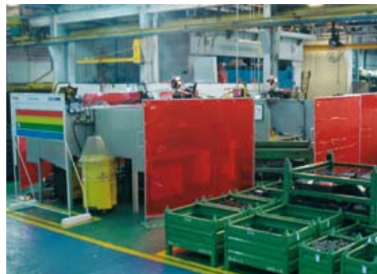
Célula de montagem do conjunto suporte de suspensão e o “Supermercado de Kanban”
