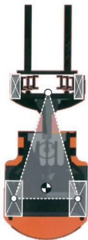
← Em uma empilhadeira articulada de quatro rodas, a distribuição de peso voltada para trás torna a **tração traseira** mais adequada
