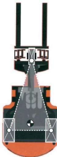
← Em uma empilhadeira articulada de três rodas, o triângulo de estabilidade é o mesmo da sua parente de quatro rodas. Entretanto, obtém-se maior tração com a distribuição de peso voltada para a frente e com **tração dianteira**
