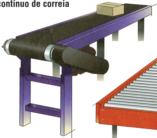
Figura 2 - Transportador contínuo de correia
