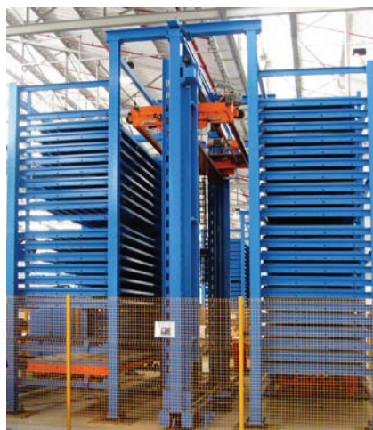
Vertical Shuttle estoca e abastece automaticamente chapas para o processo de corte a laser
