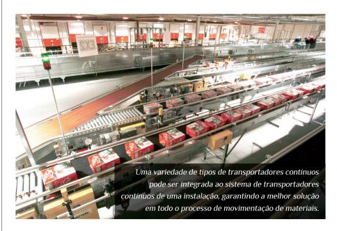
Transportador contínuo com eixo de transmissão: Em uma seção do transportador contínuo com eixo de transmissão, um eixo metálico longo passa por baixo do leito de rolos. Anéis o-ring de borracha conectam os rolos ao eixo de modo que, quando o motor gira o eixo, o eixo gira os rolos.
