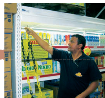
Operador isola corredor para movimentar a empilhadeira
