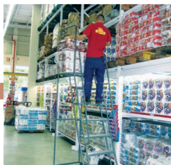
Carrinho escada e plataforma para abastecimento de gôndola
