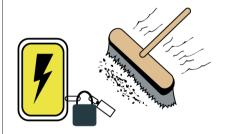
Remova a sujeira e outros objetos caídos no transportador contínuo apenas quando este estiver desligado e travado.
