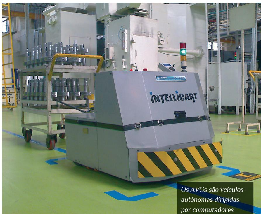
**Geometria** – Os AGVs requerem um montante previsível de caminho, de área de manobras e de espaço de tráfego variado para funcionar corretamente em um ambiente com muitas pessoas, como fábricas e armazéns. Faça um estudo tridimensional detalhado durante a fase de projeto.
