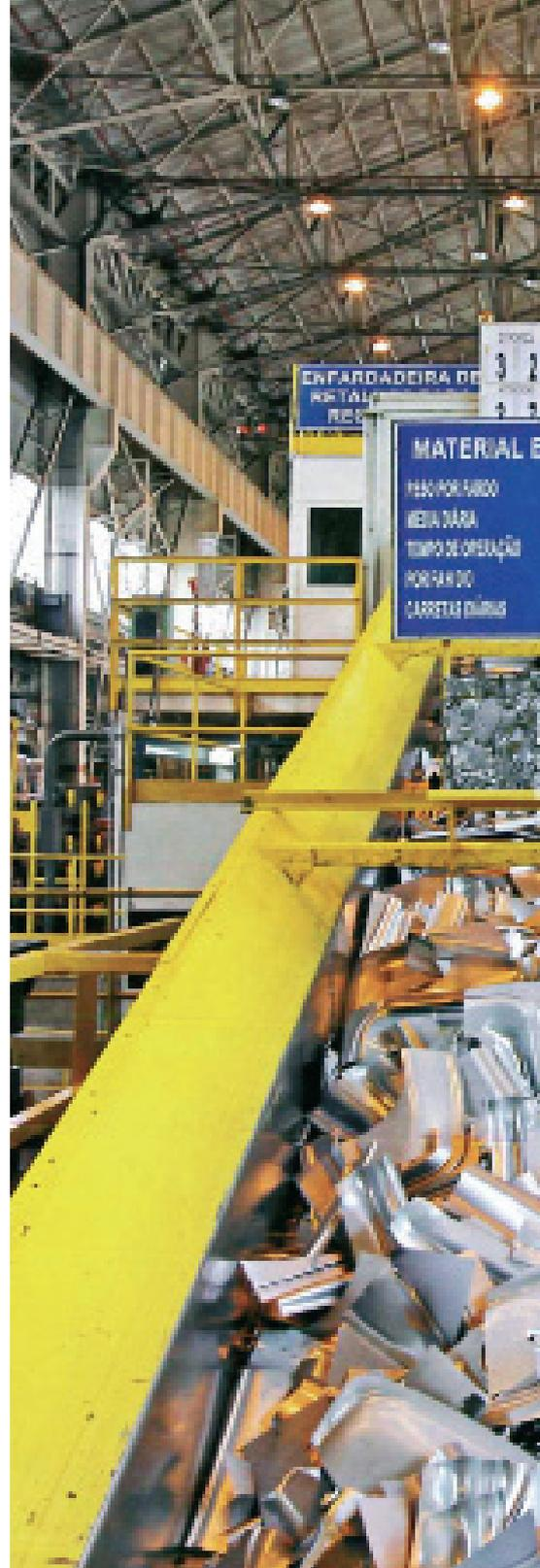
as aplicações de fundição sob pressão, as informações sobre o tamanho do cavaco, as taxas de injeções por hora, os arranjos físicos das prensas de remoção de rebarbas, os tipos de fornos e a localização são considerações importantes. Para cavacos usinados e aparas de torneamento, a composição das ligas, o volume de sucata, a quantidade de pontas de barras indesejadas de metal,
