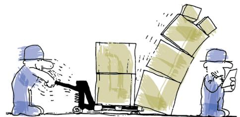
Se o comprimento dos garfos exceder ao do palete, trace uma marca nos garfos que indique até onde introduzi-los, deixando as rodas livres.
