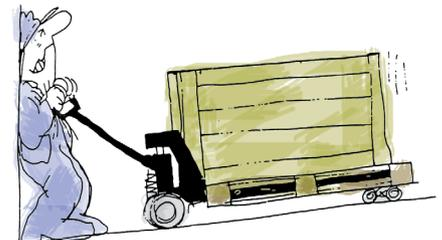
Preste atenção ao dar marcha à ré perto de uma parede ou coluna.
