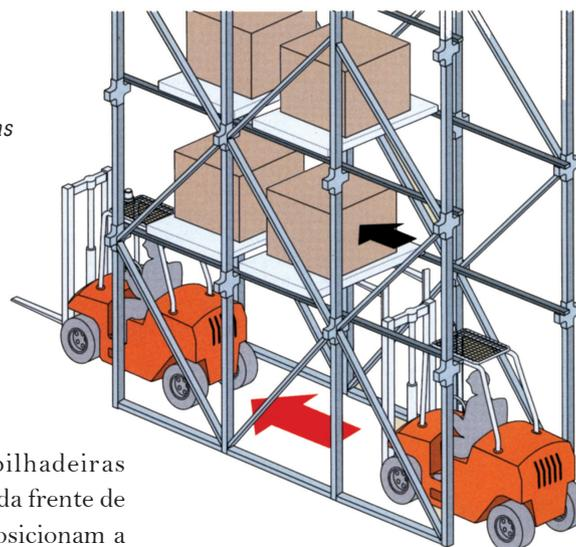
sem corredores, as empilhadeiras transitam dentro da parte da frente de uma baia de estocagem, posicionam a carga no local desejado e, em seguida, voltam de ré. Para permitir que as empilhadeiras entrem nas baias, os sistemas de trânsito interno sem corredores são projetados sem as vigas tradicionais colocadas ao longo das baias. Em vez disso, os paletes
