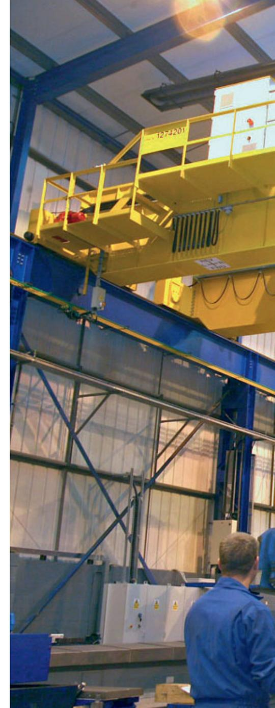
o fornecimento da capacidade, do vão livre, da altura de elevação e do trajeto necessário. As cargas impostas pela ponte rolante no prédio, no pórtico e no piso devem ser determinadas e levadas em consideração.
