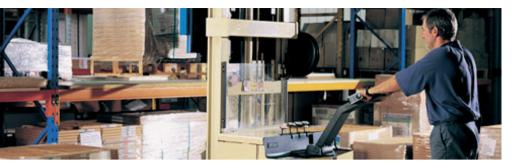
seja elevado enquanto está em pé nos garfos. Não utilize plataforma de trabalho improvisada. Assegure-se de que seu programa de treinamento foi aplicado ao operador da empilhadeira para que ele possa lidar adequadamente com esse tipo de operação.
