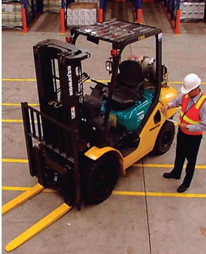
Primeiro, treine todos os operadores e supervisores de forma adequada, de acordo com as exigências do equipamento. Segundo, certifique-se de que todos operadores prestam muito atenção na estabilidade do veículo (o “triângulo da estabilidade”) e, por último, certifique-se de que todos os operadores prestam atenção nos pedestres e que todos os pedestres prestam atenção nos operadores!
