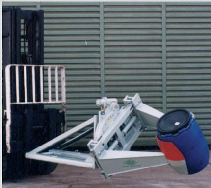
Garra mecânica para tambores, com suspensão e fixação pelo anel superior
